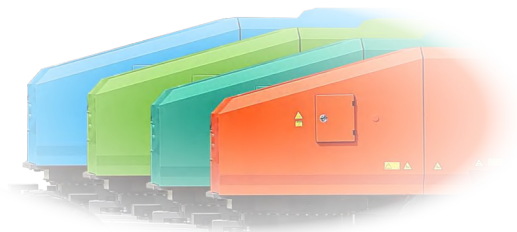
De series diesel, mild hybrid, elektrisch en bereikvergroter worden ontwikkeld op hetzelfde platform, waarbij 85% van alle onderdelen gemeenschappelijk zijn.
